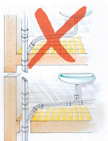
Fig. EV-04. Instalación sin manipulación de la tubería.
