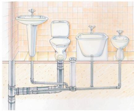
Fig. EV-03. Desagüe de aparatos sanitarios con bote sifónico
